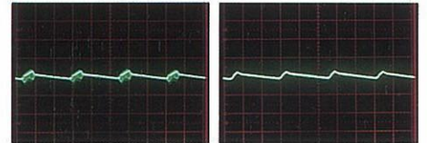
従来の電源で整流されたB電圧波形。AC電源の汚れがそのまま表われています。
